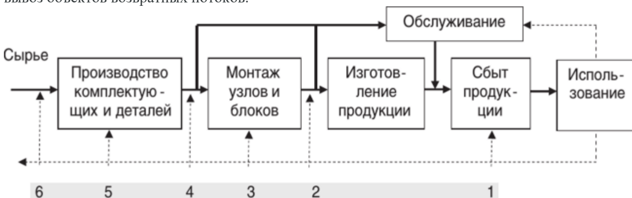
Рис. Базовая модель логистической сети возвратных потоков М. Флейшмана (1 - перепродажа, 2 - текущий ремонт, 3 - восстановление, 4 - повторное производство, 5 - ликвидация, 6 - вторичное использование ресурсов)
